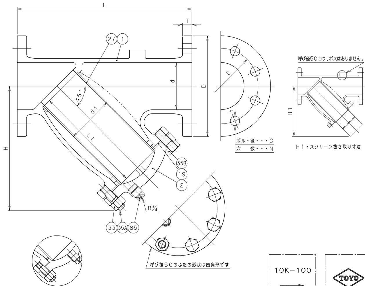
呼び径50スクリーンの構造
