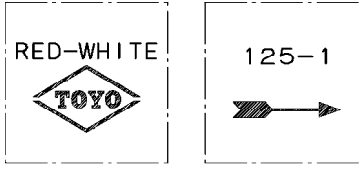
弁箱 casting 表示例
