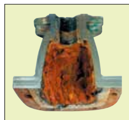
激しく腐食した鑄鉄バルブの内部
