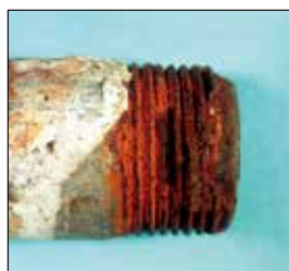
ねじが欠落したライニング鋼管
