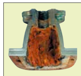
激しく腐食した鑄鉄バルブの内部
