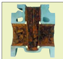
激しく腐食した鑄鉄バルブの内部
