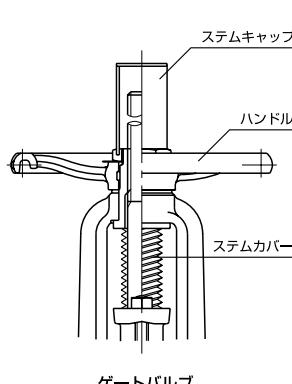
屋外や屋外に準じた環境に設置する場合、砂塵や腐食等、バルブの有害物からシステムを保護します。システムキャップ(インジケータ付(開閉位置表示)も製作いたします。
