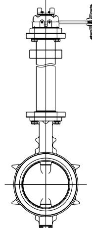
埋設配管や水没配管などではバルブの操作部を延長したものが使用されます。ピット内にフロアースタンドを設置したり、システム軸を延長して開栓器で操作する方式など、仕様に合せて製作いたします。
