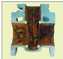
激しく腐食した鑄鉄バルブの内部
