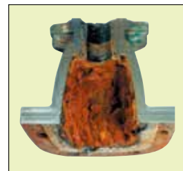
激しく腐食した鑄鉄バルブの内部
