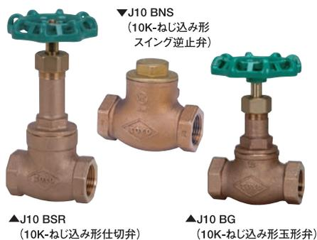
JIS規格バルブ（JIS B2011）は、工業標準化法に準拠した設計及び品質管理で製造した規格型バルブです。構造は、ゲート・グローブ・スイングチェッキがあります。水道法による「給水器具」、消防法による「消防・防災装置」、国土交通省による「公共建築工事標準仕様書」などに安心してご利用いただけます。
