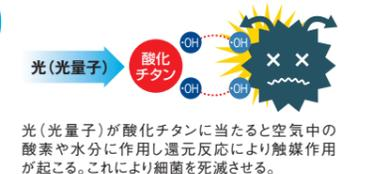
光触媒は、光(光量子)によって荷電分離が発生し酸化や還元反応の触媒作用を示します。このとき水があるとOHラジカルが発生し、殺菌と有機物の分解ができます。
