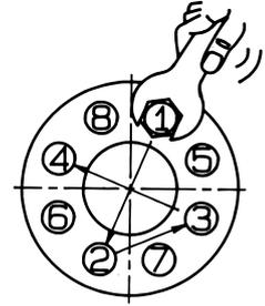
(3) 片締めによる漏れを防ぐために、フランジ形・ウェハー形では、フランジボルトを“十字手順”で反復しながら接合面に均一な面圧が発生するように締付けてください。
