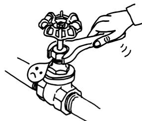
使用中漏れが続くと漏れ筋が発生して、増締めしても漏れが止まらない場合があります。日常点検を行い、早期に増締めを実施してください。
