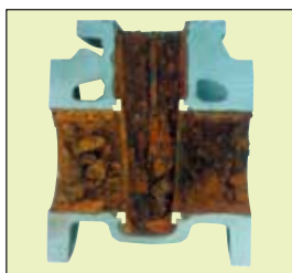
激しく腐食した鑄鉄バルブの内部
