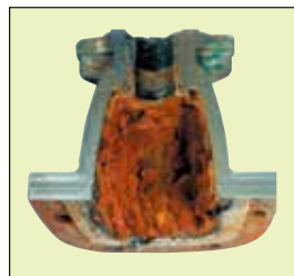
激しく腐食した鑄鉄バルブの内部
