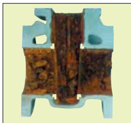
激しく腐食した鑄鉄バルブの内部
