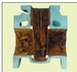
激しく腐食した鑄鉄バルブの内部
