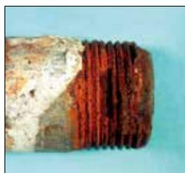
ねじが欠落したライニング鋼管
