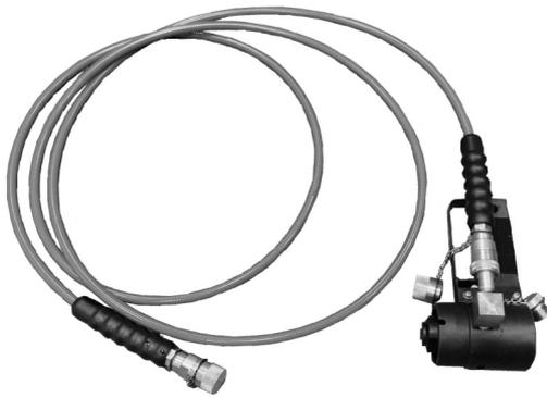
Iの電動式拡張機に油圧ホース(長さ4m)を介して拡張。
