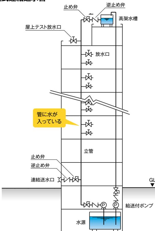
図2 乾式連結送水管
