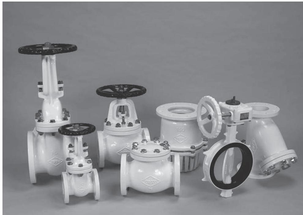
近年、バルブを含む配管機器の腐食による赤水の流出や、錆による流量低下、機能障害などの発生は社会問題となっています。腐食は金属と環境との相互作用によって生じ、赤水となって現れることから、この防止対策としてはおもに、①腐食環境の改善、②腐食環境の遮断、③使用材料の変換などが考えられます。東洋ライニングバルブは、腐食原因となる金属をナイロン11樹脂でシェイプアップ—金属部が接水しない方法を採用し、赤水を追放しました。
