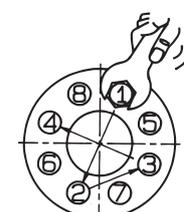
(3) 片締めによる漏れを防ぐために、フランジ形・ウェハー形では、フランジボルトを“十文字手順”で反復しながら接合面に均一な面圧が発生するように締付けてください。
