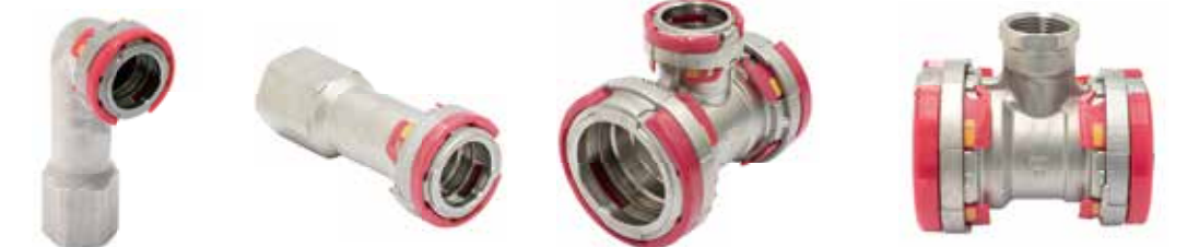
給水栓ロングエルボ 壁が厚くても、持ち出し ソケット等は不要です。 末端の器具取付用 給水栓ロングソケット 壁内、床貫通部末端の 器具取付用。 給水栓固定金具が必要です。 三方径違いチーズ 通り配管のサイズを1サイズ変更 できます。 枝側は20又は25Su 三方径違いメスネジチーズ 通り配管のサイズを1サイズ変更 できます。 枝側はRc3/4
