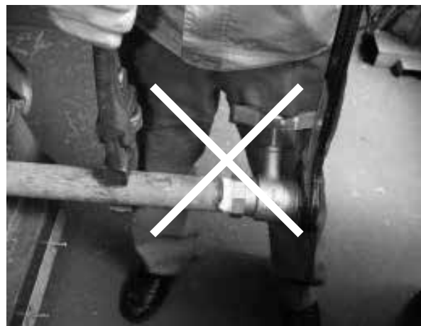
ねじ込む側の反対側に工具を掛けている
